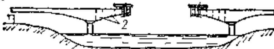
Рисунок. Схема навесного бетонирования: 1. – перемещаемые подвесные подмости; 2. – секции бетонирования
