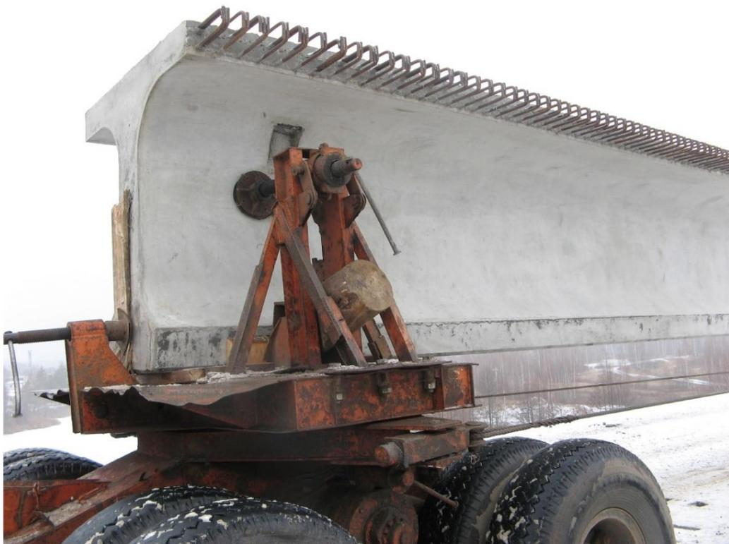
Рисунок. Узел крепления балки на балковозе
