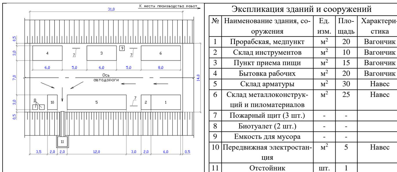
Рисунок. План строительной площадки
