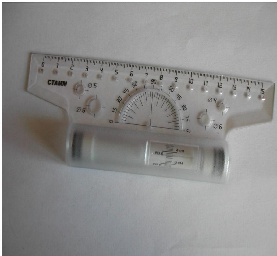
Рис. 3. Рейсшина. Используется для проведения параллельных линий
