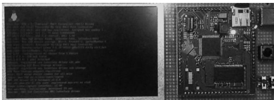
Рисунок 1 – Беспроводной ультразвуковой дефектоскоп МД-1
