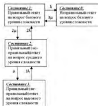
Рис.2 Граф переходов МПТ (последовательный, с одним конечным уровнем)
