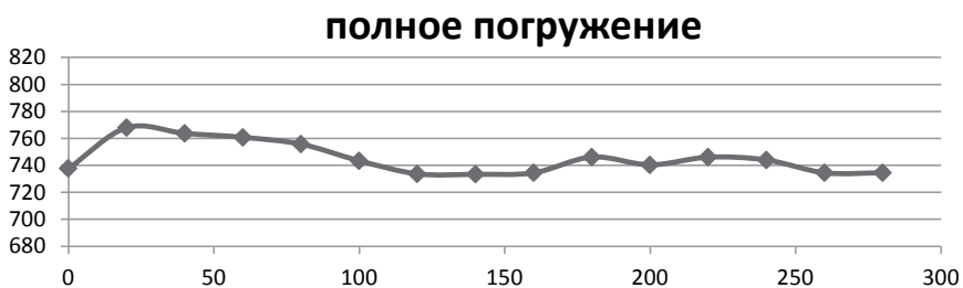
Рисунок 1. Кинетика изменения массы образцов при определении термостойкости бетона («облегченный» без металлической фибры)
