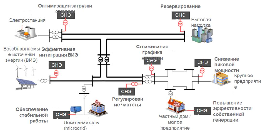
Рисунок 2 – Использование ВИЭ на всех уровнях энергосистемы
