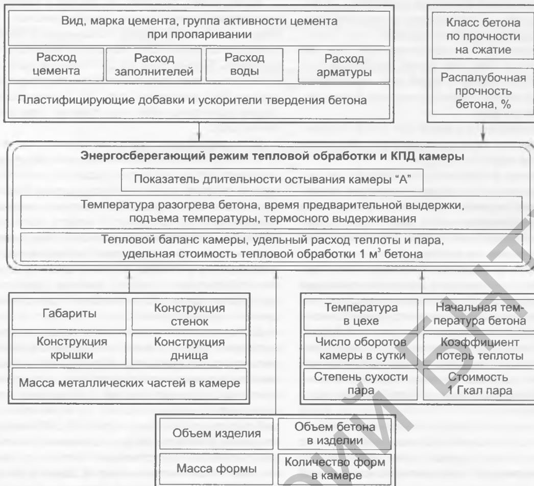
Рис. 3. Схема расчета энергосберегающих режимов тепловлажностной обработки бетона, положенная в основу программного продукта
