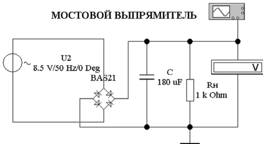
Рис. 16.7. Мостовой выпрямитель с C-фильтром (файл rect_2.ewb )
