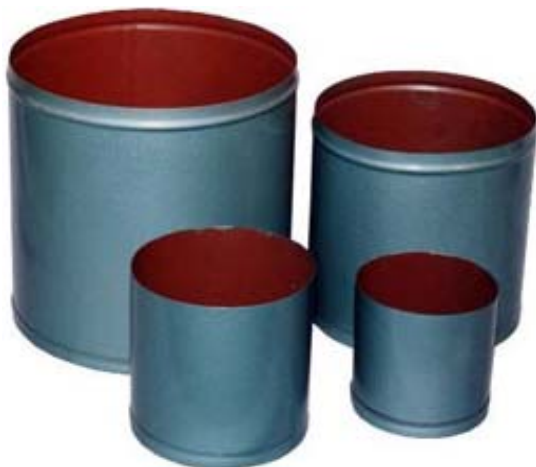
Рис. 1.4. Мерные сосуды емкостью 10, 5, 2 и 1 литр для определения насыпной плотности заполнителей
