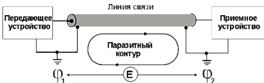
Рис. 7.7. Образование паразитного контура при нескольких точках «зануления»
