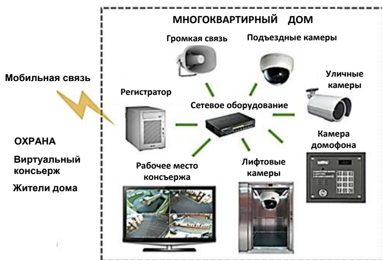
Рис. 5.3. COT многоквартирного дома
