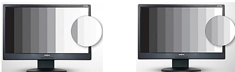
Рис. 3.42. Отображение шкалы серого на мониторе при неправильной и правильной настройке контраста
