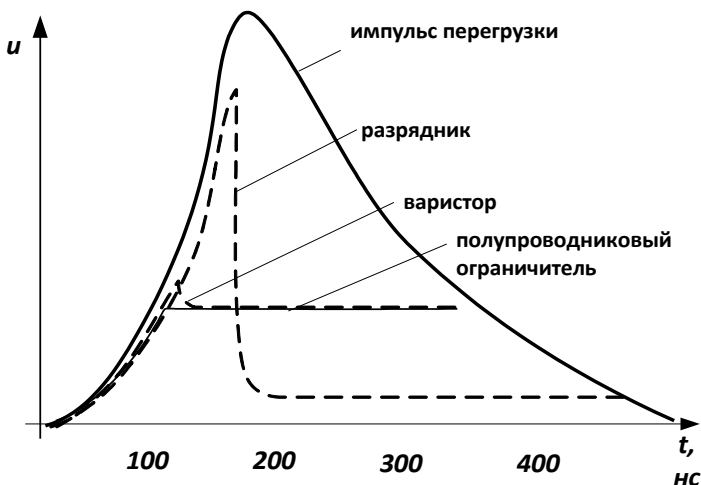
Рис. 7.15. Вольт-временные характеристики ограничителей напряжения
