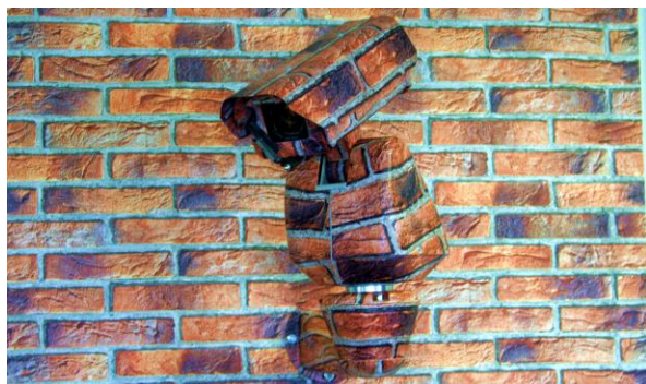
Рис. 5.10. Маскирующая окраска камеры и поворотного устройства
