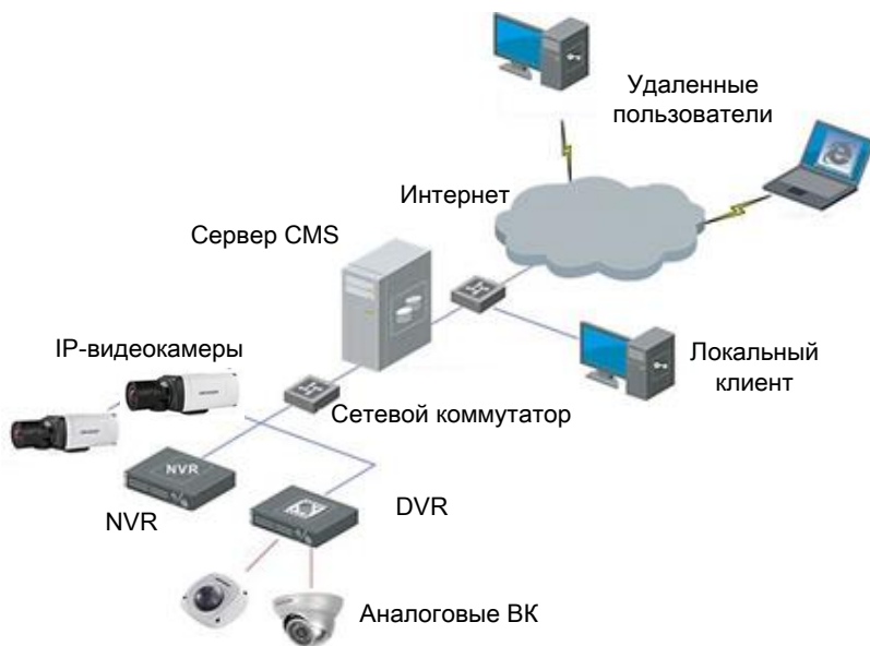
Рис. 1.7. Структура «гибридной» СОР
