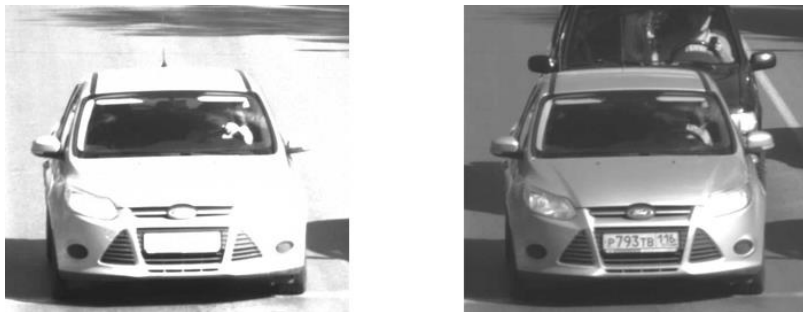
Рис. 3.48. Реакция на появление солнца и засветку номера в системе VOCORD Traffic (камеры NetCam4 )
