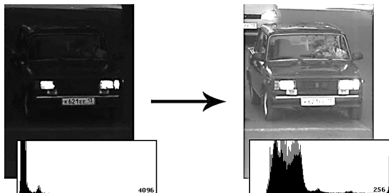
Рис. 3.47. Осветление изображения в камере для распознавания номеров с 12-битным кодированием
