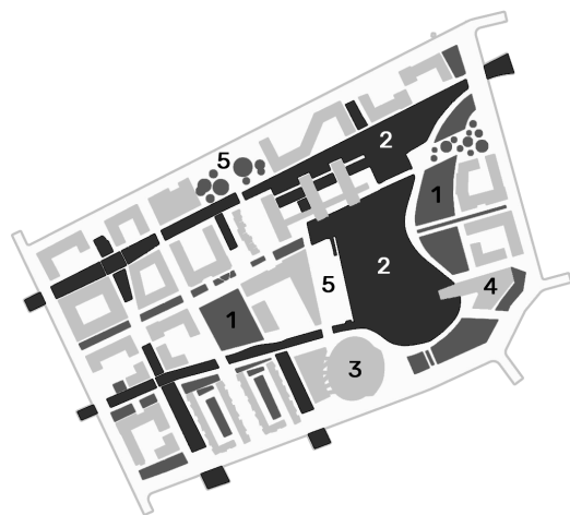
Рис. 1. Водно-зеленый каркас как основа планировки жилого образования: 1 – озелененные пространства; 2 – искусственные каналы; 3 – спортивная арена; 4 – многофункциональный комплекс; 5 – открытые общественные пространства
