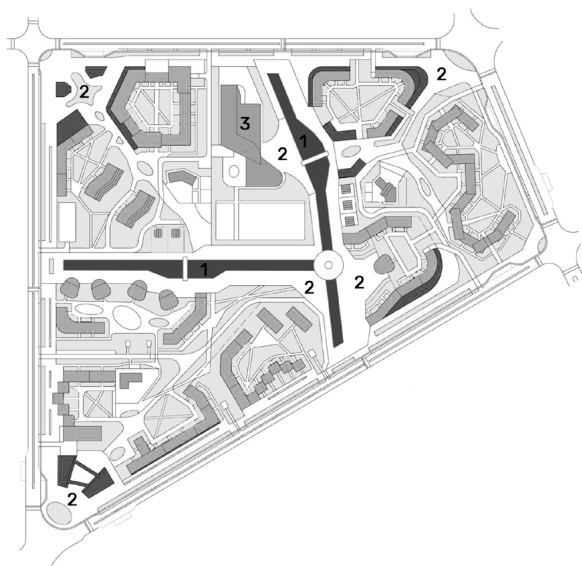
Рис. 4. Генплан жилого образования как совокупность автономных жилых единиц: 1 — искусственные каналы; 2 — открытые общественные пространства; 3 — школа
