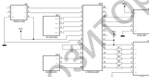
Рисунок 1 – Электрическая схема УВП
