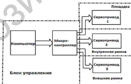
Рисунок 1 – Блок-схема макета управляемой платформы
