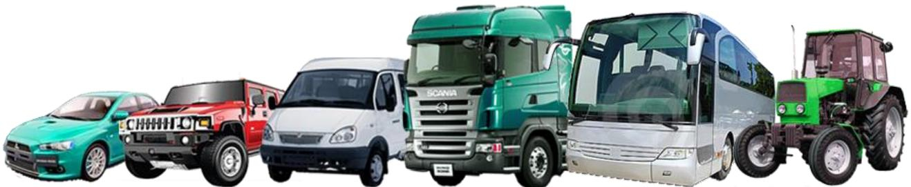
**Personenkraftwagen** (Pkw) sind für die Beförderung der Menschen bestimmt. Sie bieten Platz für 2 bis 8 Personen je nach der Karosseriegröße. Je nach der Karosserieart unterscheidet man Coupés, Limousinen, Kombiwagen, Kabrioletts sowie verschiedene Sonderkonstruktionen. Sie haben – bis auf wenige Ausnahmen – einen Viertakt-Ottomotor.
