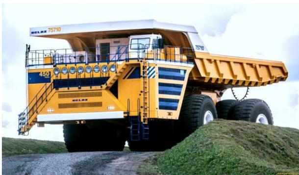
Für die größten Lkw der Welt ist die Straße tabu, sie sind zuhause in Minen, in denen Kies und Kohle, Erze, Kupfer, Gold, Diamanten und Ölsand abgebaut werden. Der derzeit größte und schwerste Lkw der Welt ist der BelAZ 75710 aus Belarus. Der Mega-Lkw kann eine Nutzlast von bis zu 450 Tonnen transportieren und erreicht ein Gesamtgewicht von 810 Tonnen! Die bisher
