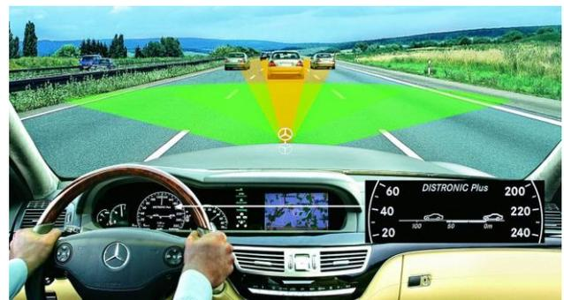
**(Intelligent Speed Adaption – ISA):** Durch Informationen aus dem Navigationssystem oder einer Verkehrszeichenerkennung unterstützt die Technik die Einhaltung der erlaubten Geschwindigkeit beim Fahren.
