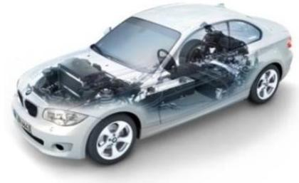
Die Kraftübertragung ist eine Einheit von Baugruppen und Aggregaten, die das Drehmoment des Motors auf die Antriebsräder übertragen und seine Größe und Richtung ändern. Zur Kraftübertragung gehören Kupplung, Schaltgetriebe, Gelenkwelle, Ausgleichgetriebe (auch als Differentialgetriebe oder kurz Differential bezeichnet) und Achsantrieb.
