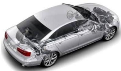
Bremskraftverteilung (EBV), der Bremsassistent, die Antischlupfregelung (ASR), das Antiblockiersystem (ABS) und das elektronische Stabilitätsprogramm (ESP) sind heute selbstverständliche Bestandteile des Fahrwerks.
