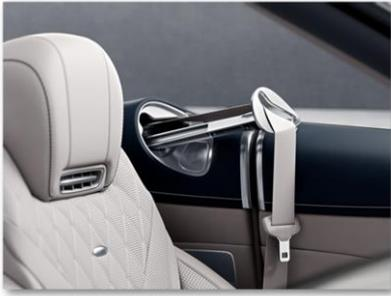
Sicherheitsgurt bei einem Aufprall zu straffen, sodass ein Fahrzeuginsasse nicht nach vorne geschleudert wird. So wird der Gurt bei einem Aufprall automatisch innerhalb von 10 bis 15 Millisekunden angezogen. Moderne Gurtstraffer wirken mit einer Kraft von etwa zwei Kilonewton auf die Schulter des Fahrzeuginsassen. Das entspricht einem Druck von etwa 200 Kilogramm. Bei ordnungsgemäßem Anlegen des Sicherheitsgurtes kommt es dabei jedoch nur selten zu Verletzungen.
