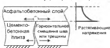
Рис. 5. Напряжения в асфальтобетонном слое покрытия на цементобетонном основании, вызванные суточными колебаниями температуры
