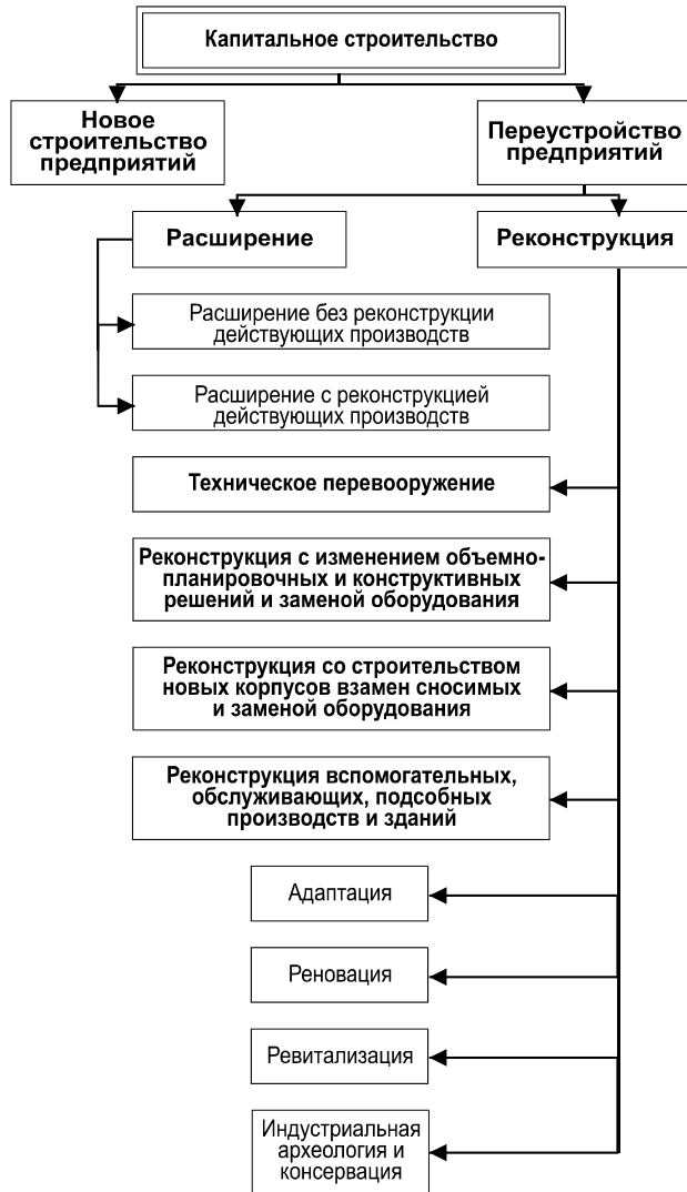
Рис. 1.1. Место реконструкции в капитальном строительстве промышленных предприятий
