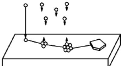
**Рисунок 1 – Схема осаждения атомов и образования ориентированных слоев**
