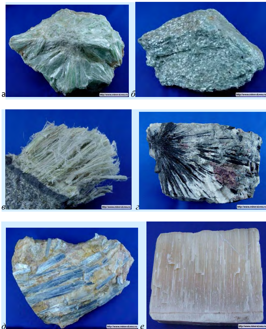
Рис. 31. Листоватый агрегат – тальк (а), среднечешуйчатый агрегат – паргонит (б), длиноволокнистый агрегат – хризотил асбест (в), радиально-лучистый агрегат – эгирин (г), шестоватый агрегат – кианит (д), волокнистый агрегат – гипс селенит (е)
