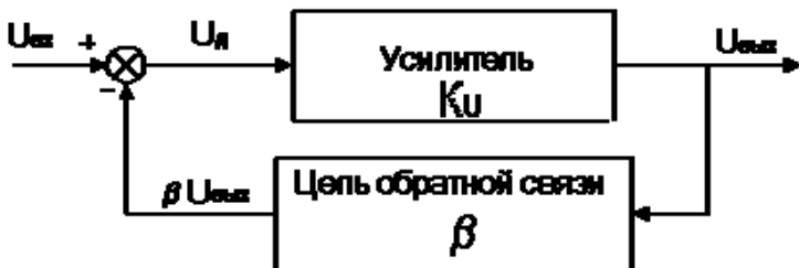
Рис. 4.16. Принцип действия отрицательной обратной связи
