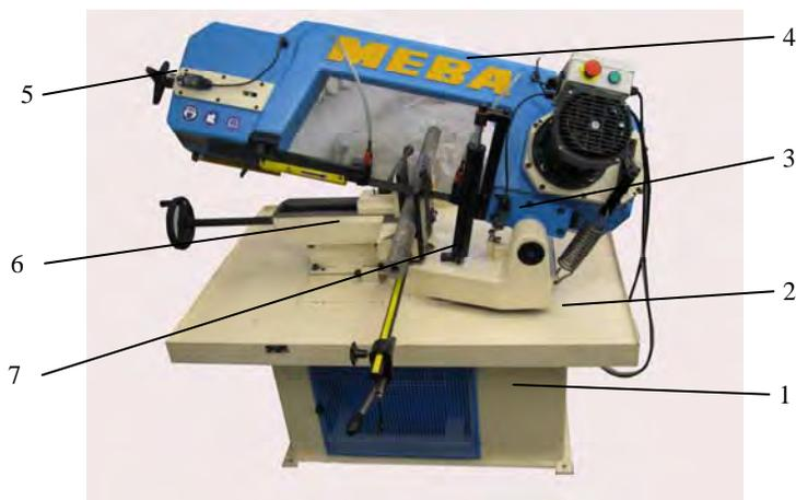
Рис. 36. Общий вид консольного ленточнопильного станка:
