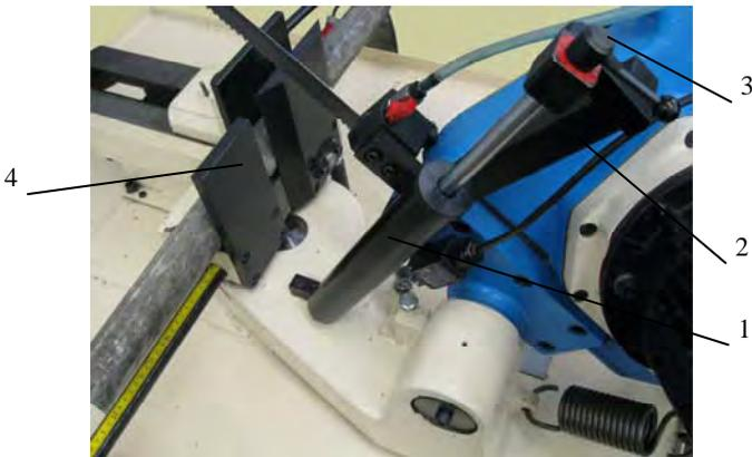
Рис. 38. Узел управления перемещением пильной рамы:
