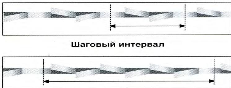
Рис. 18. Разводка зубьев стандартная
