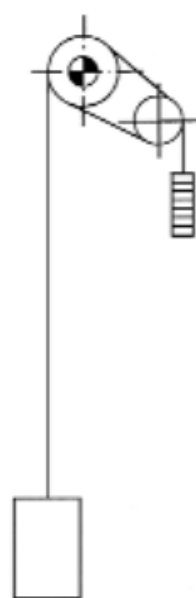
Рисунок 5.3 - Канатная система с верхним расположением лебедки, привод с двойным обхватом, кратность канатной подвески 1
