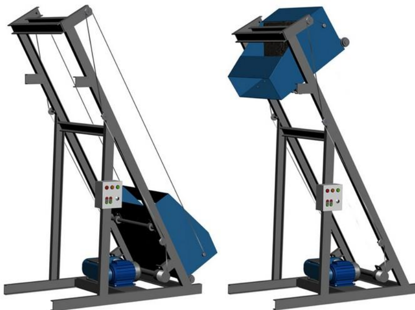
Рисунок 9.2 – Скиповый подъемник с опрокидывающимся скипом
