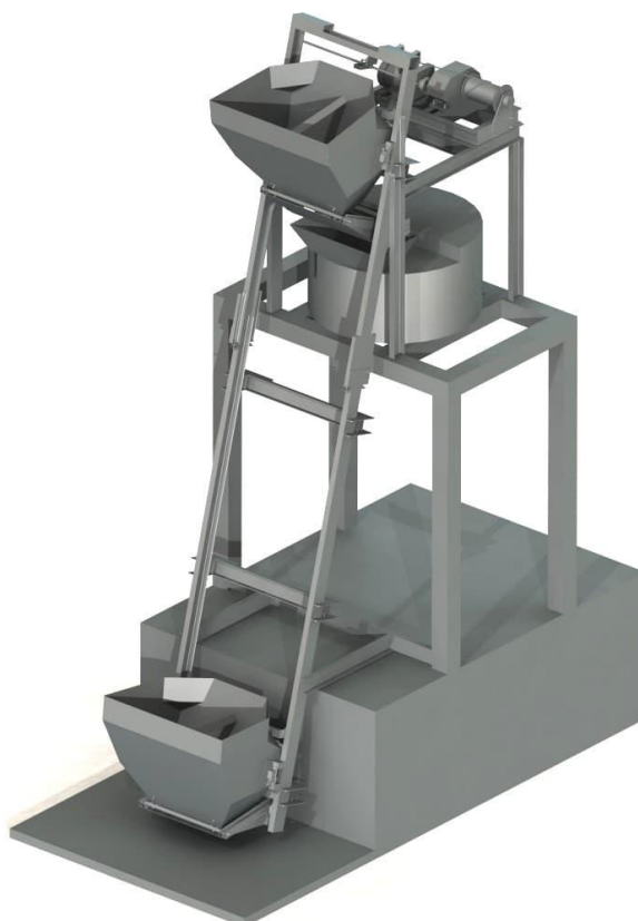
Рисунок 9.1 – Скиповый подъемник с донной разгрузкой скипа
