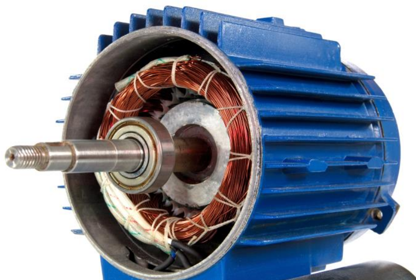
Рисунок 7.2 – Расположение ротора в расточке статора
