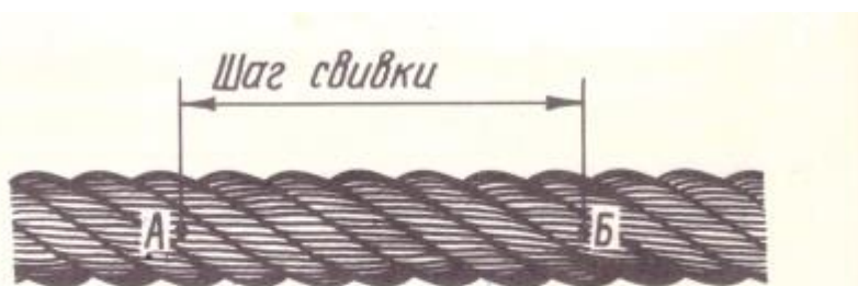
Рис. 39. Пример определения шага свивки шестипрядного каната
