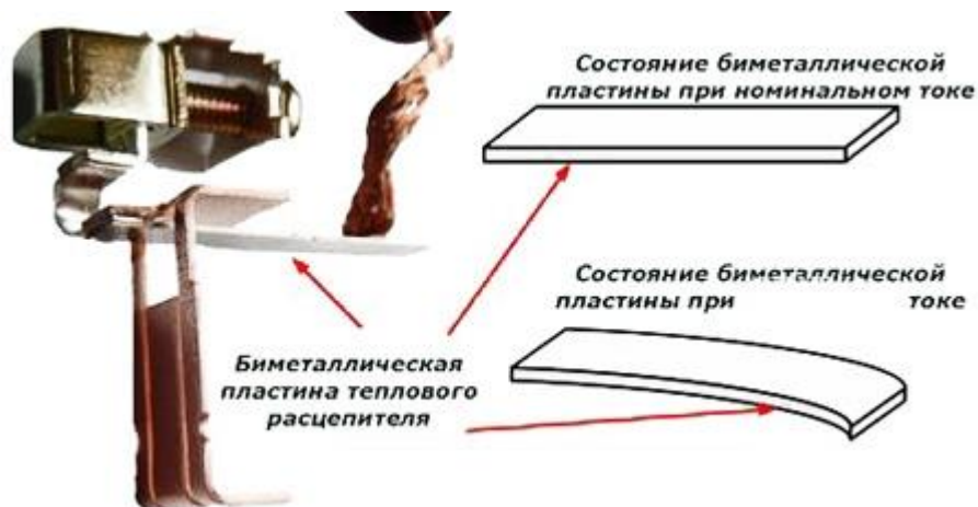
Рисунок 10.5 – Срабатывание биметаллической пластины теплового расцепителя
