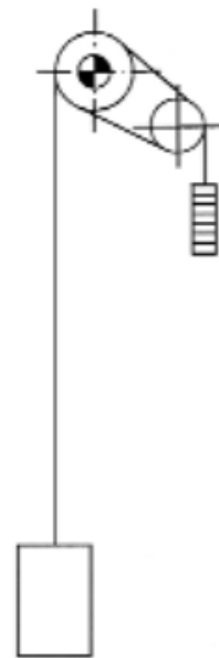
Рисунок 1.4 - Канатная система с верхним расположением лебедки, привод с двойным обхватом, кратность канатной подвески 1
