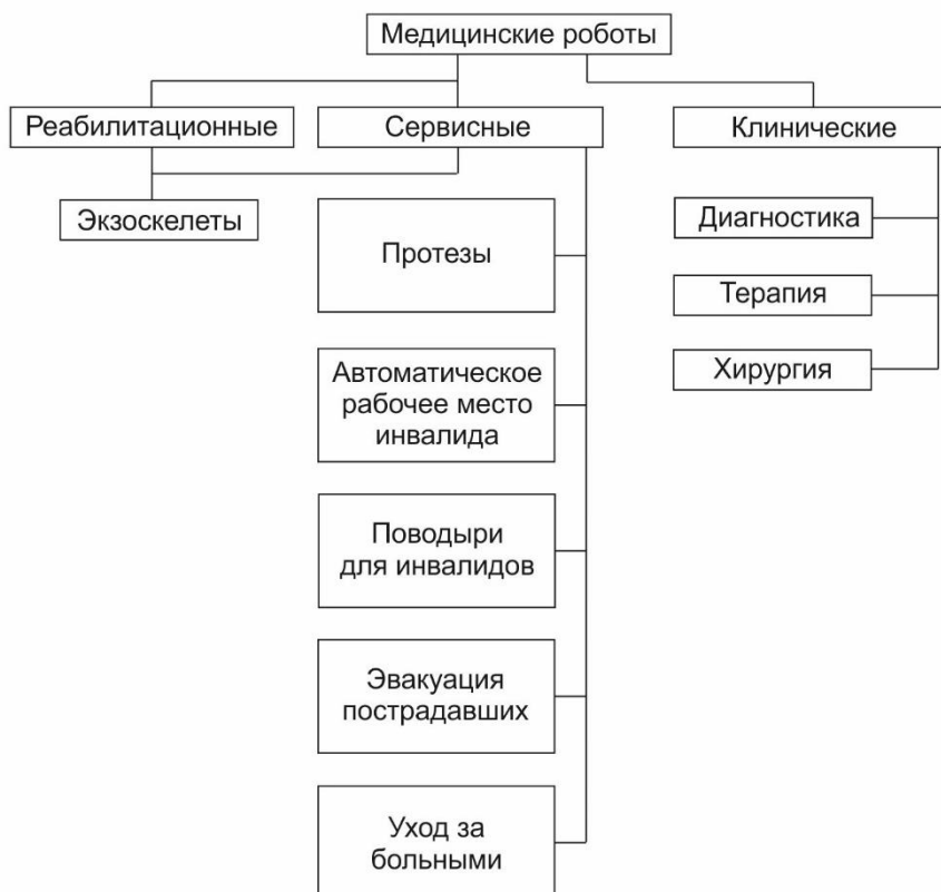
Рис. 1. Классификация робототехнических систем в медицине
