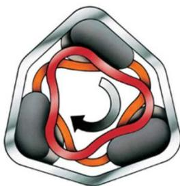
Рис. 3. Деформации жгутов при работе РЖЭ
