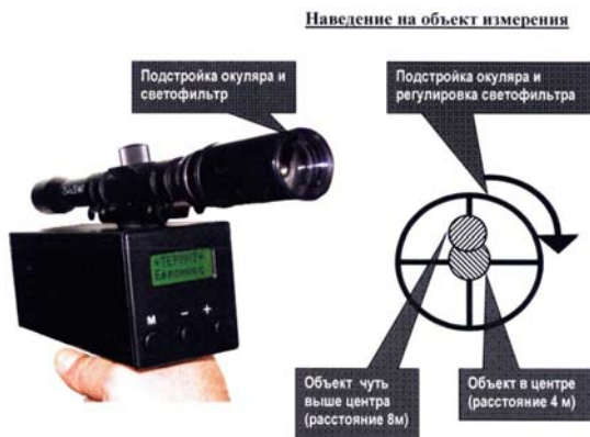
Рис. 1.4. Схема измерения температуры пирометром «Кельвин Б1»
