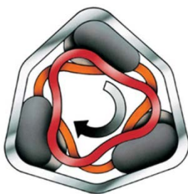
Рис. 3. Деформации жгутов при работе РЖЭ
