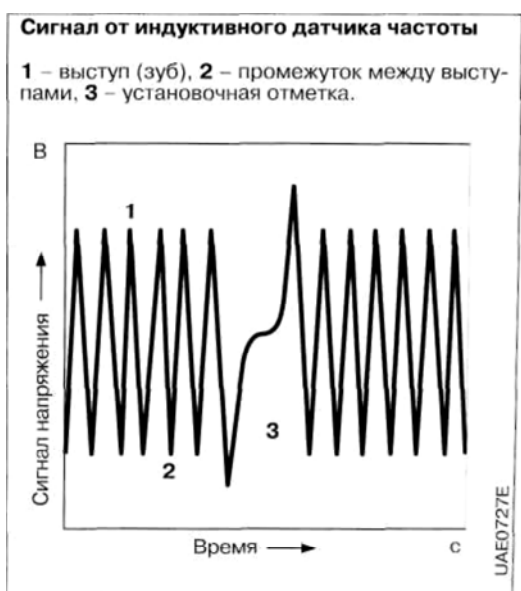
Рис. 3.8. Осциллограмма сигнала с ДПКВ
