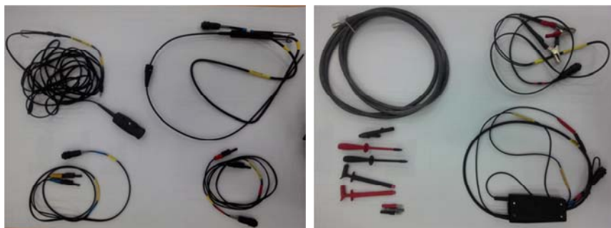
Рис. 1.3. Мотор-тестер и основные принадлежности: а – трехканальный провод для генератора сигналов; токоизмерительные клещи 30 А; датчик вторичных цепей зажигания; токоизмерительные клещи 1000 А; б – мобильный измерительный модуль; блок питания 19V DC; кабель USB; USB-адаптер Bluetooth
