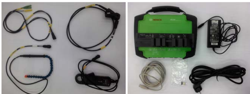
Рис. 1.3. Мотор-тестер и основные принадлежности: а – трехканальный провод для генератора сигналов; токоизмерительные клещи 30 А; датчик вторичных цепей зажигания; токоизмерительные клещи 1000 А; б – мобильный измерительный модуль; блок питания 19V DC; кабель USB; USB-адаптер Bluetooth
