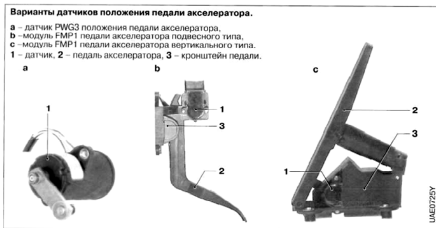
Рис. 3.3. Датчик положения педали акселератора
