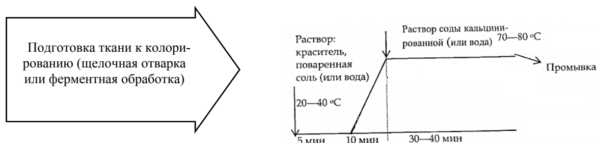
Рис. 1 – Схема подготовки и крашения хлопчатобумажных и льняных тканей периодическим способом
