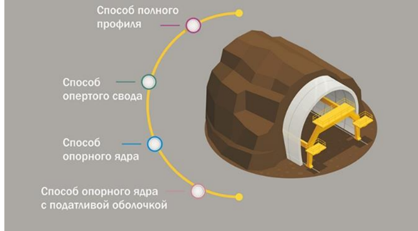
Рисунок 8 – способы строительства тоннеля
