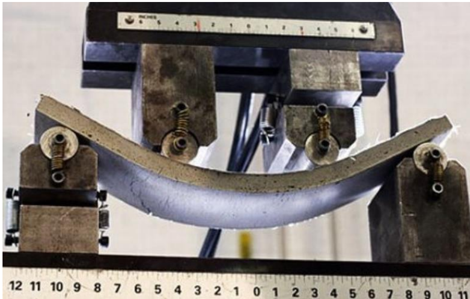
Рисунок 4 – Испытание «самозалечивающегося» эластичного бетона
