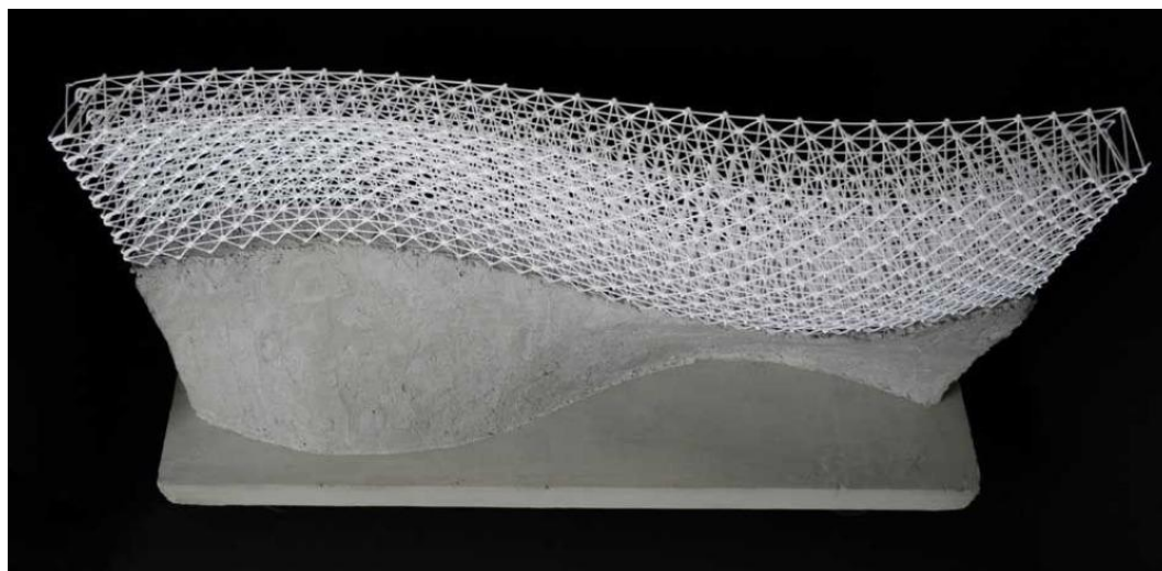
Рисунок 1 – Структура гибкого бетона ConFlexPave
