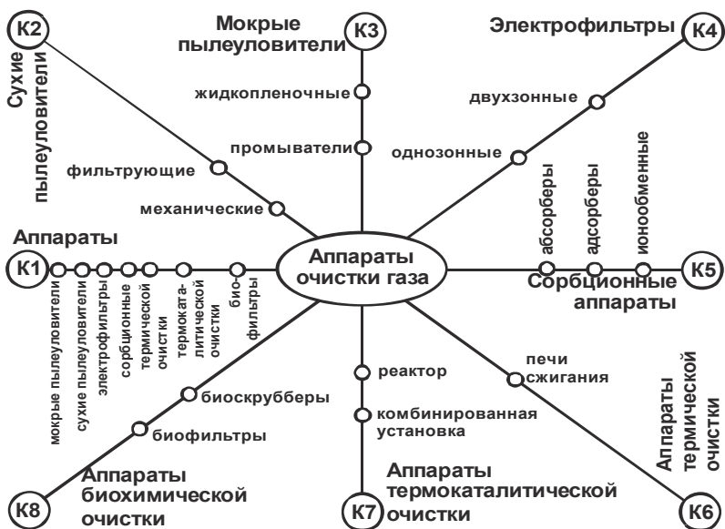
Рис. 4.12. ЛСМ «Аппараты очистки газа на предприятии по производству упаковки»
