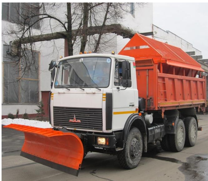
Рисунок 11 - Общий вид снегоуборочной машины на базе автомобиля МАЗ
