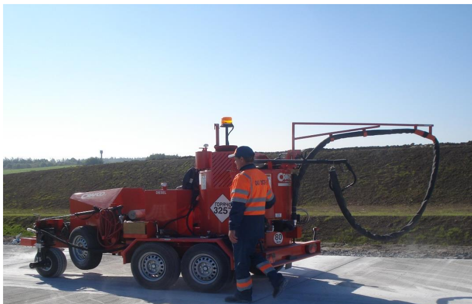
Рисунок 33 - Внешний вид котла-заливщика Crafcro Super Shot
