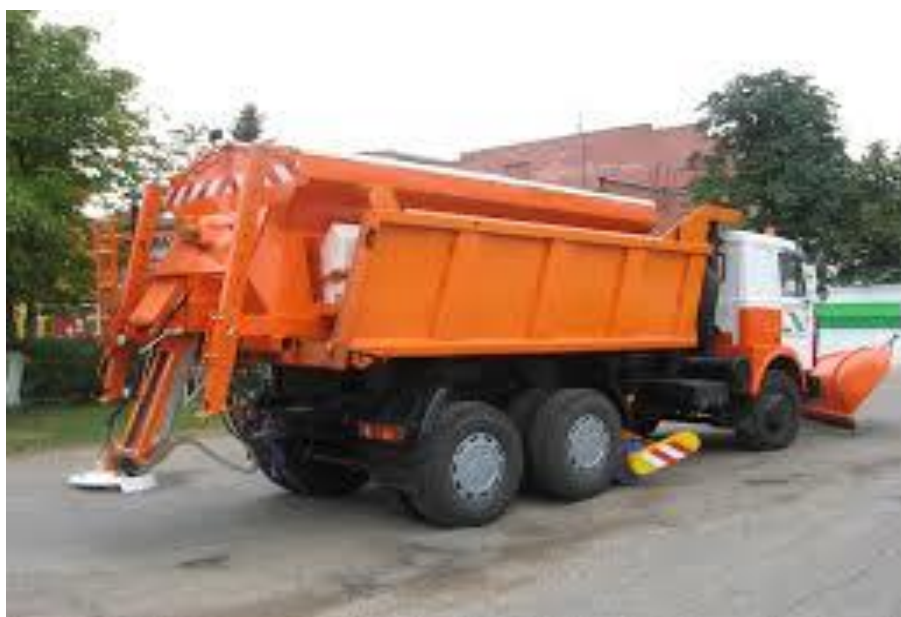
Рисунок 16 - Общий вид снегоуборочного оборудования SCHMIDT на базе автомобиля МАЗ-5516
