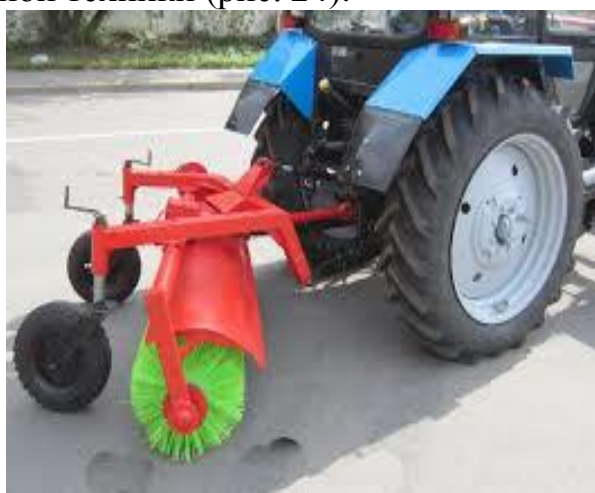
Рисунок 24 - Подметательно-уборочное навесное оборудование
