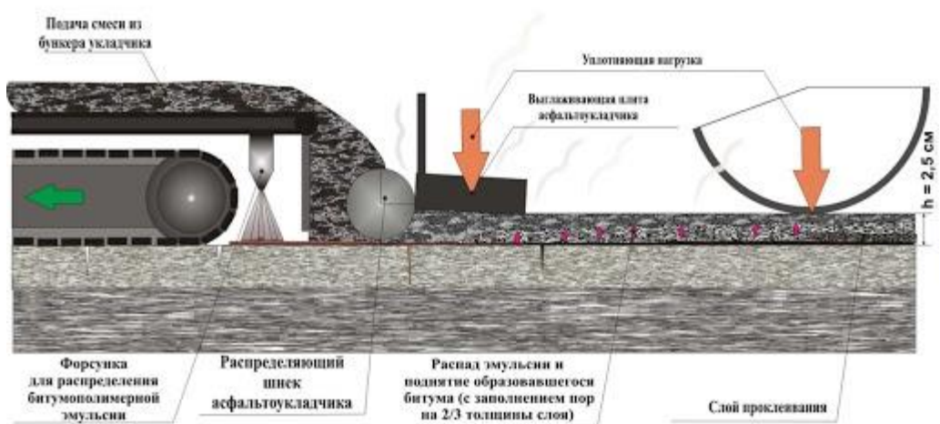
Рис. 6. Технология устройства тонких защитных слоев «Тонфриз»
