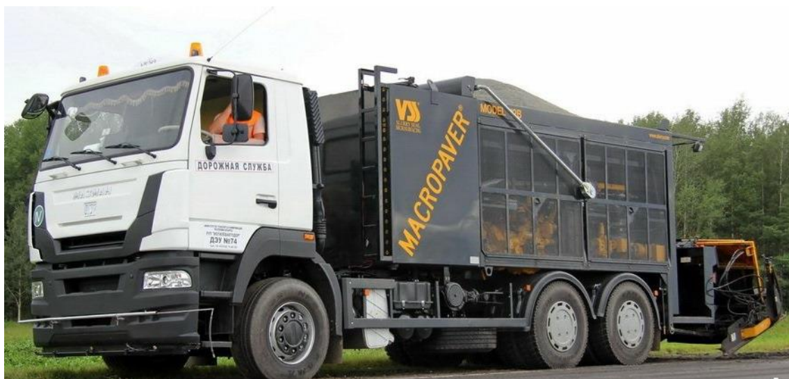
Рисунок 47 - Общий вид смесителя-укладчика MacroPaver 12B
