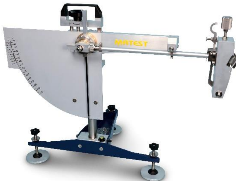
Рисунок 3 – Прибор маятникового типа
