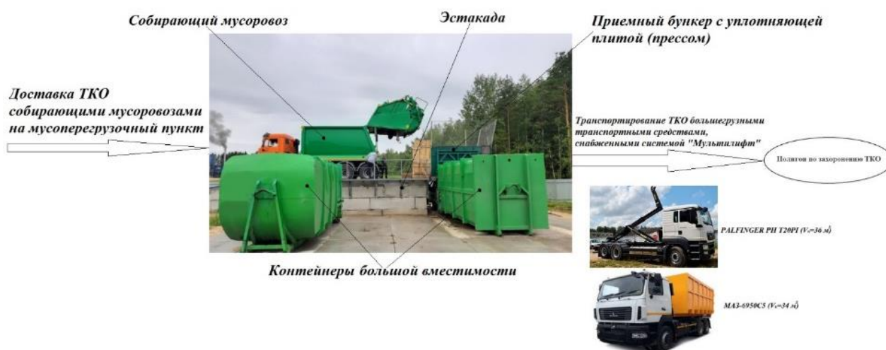
Рисунок 2 – Двухэтапная система сбора и транспортирования ТКО с перегрузочным пунктом
