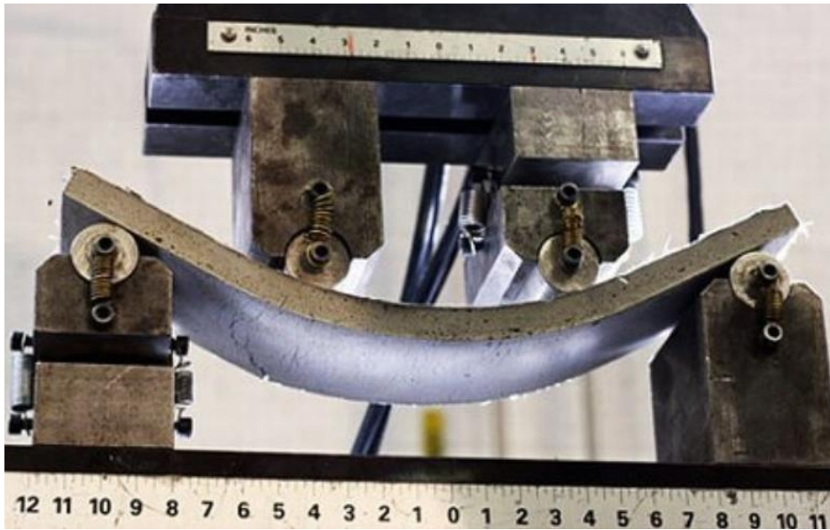
Рисунок 4 – Испытание «самозалечивающегося» эластичного бетона
