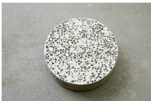
Рисунок 1 – Биобетон. Споры бактерий хранятся в иммобилизованном виде в отдельных упаковках
