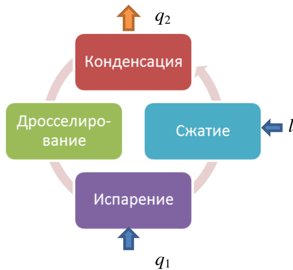
Рисунок 2. Цикл теплового насоса
