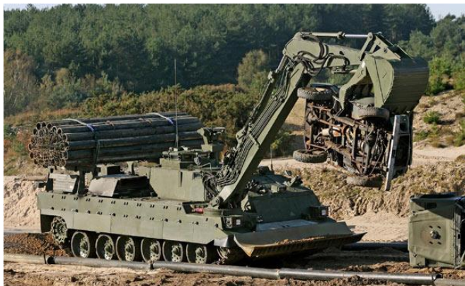
Рисунок 2 – Бронированная инженерная машина «Троян» (Trojan)
