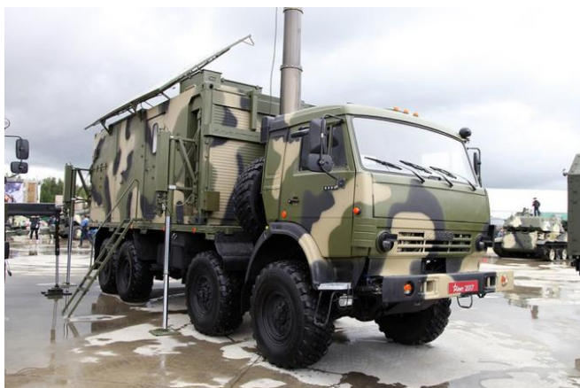
Рисунок 2 – Передвижная гибридная станция СГДЭС-30
