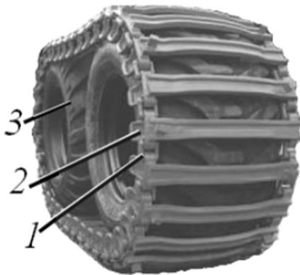
Рисунок 3 – Легкосъёмная металлическая гусеница на колесах балансирной тележки:
