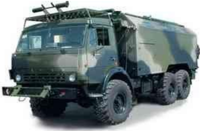
Рисунок 1 – Мастерская ремонтно-слесарная MPC-AMP
