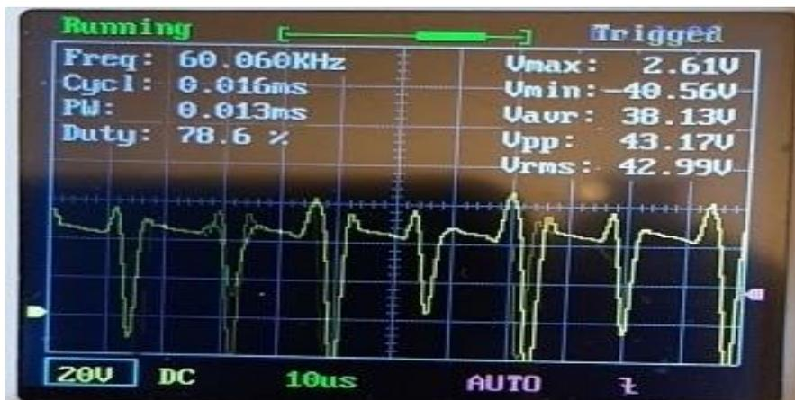
Рис. 5 Осциллограмма выходного напряжения с частотой 60,06 кГц.
