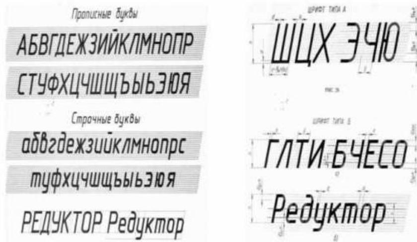
Шрифты наклонные. Угол наклона  $75^\circ$
