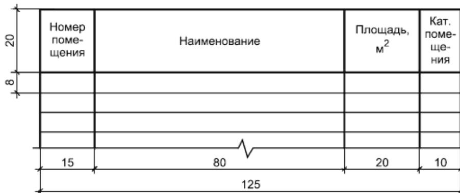
Рисунок 3.5.3. – Экспликация помещений
