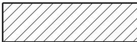
Рисунок 2.2.2. –Обозначение элементов генеральных планов и сооружений транспорта, подлежащих реконструкции
