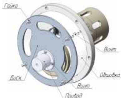
Рис. 8. Конструкция проектируемого ввода
