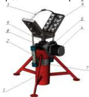
Рис. 3. Устройство регулируемой опоры вакуумной установки: 1- корпус; 2 - пневмоцилиндр; 3 - хомут; 4 - электродвигатель; 5 - фланец; 6 - охват; 7 - кольцевой кронштейн; 8 - редуктор; 9 - винт
