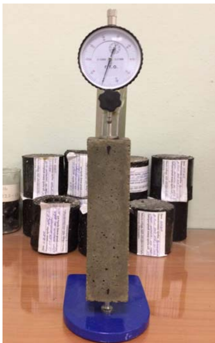
Рис. 4.5. Оценка усадки бетона с помощью устройства УБ-40
