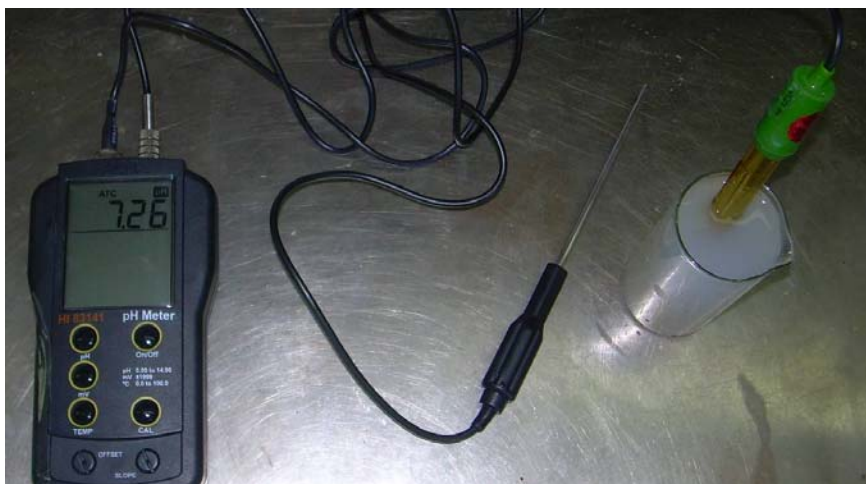
Рис. 2.3. Портативный рН-метр HI 83141
