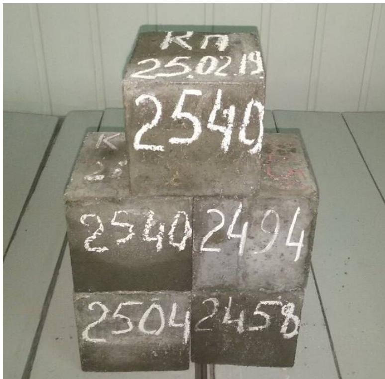
Рис. 4.9. Образцы бетона после 37 циклов замораживания-оттаивания в 5 %-ном растворе NaCl
