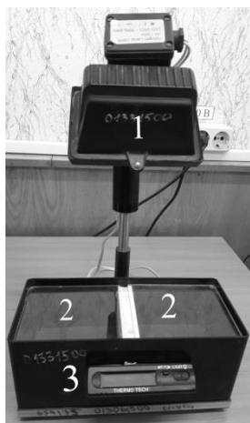
Рисунок 2. Лабораторная установка для моделирования парникового эффекта.
