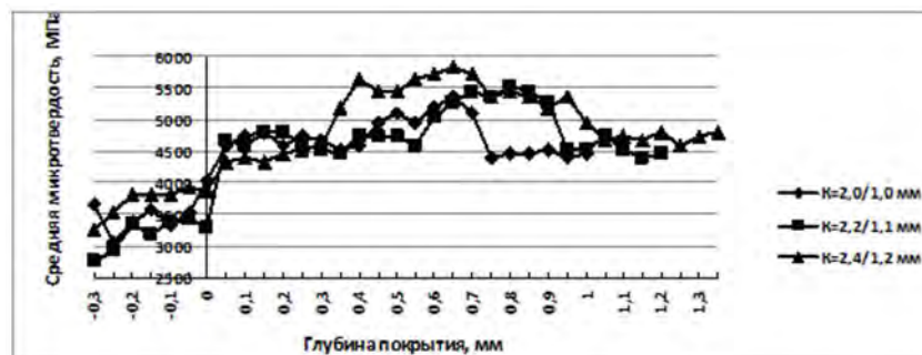
Рис. 2. Распределение микротвердости по глубине двухслойного мультимодального покрытия из сплава ПГ-12Н-01 и бронзы ПГ-19М-01 (валик из бронзы внизу)
