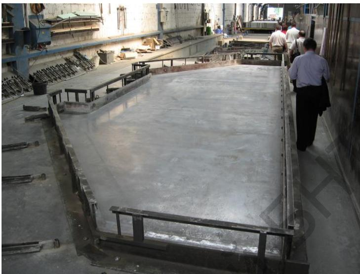
Рисунок 3. Производство стеновой панели нестандартной формы
