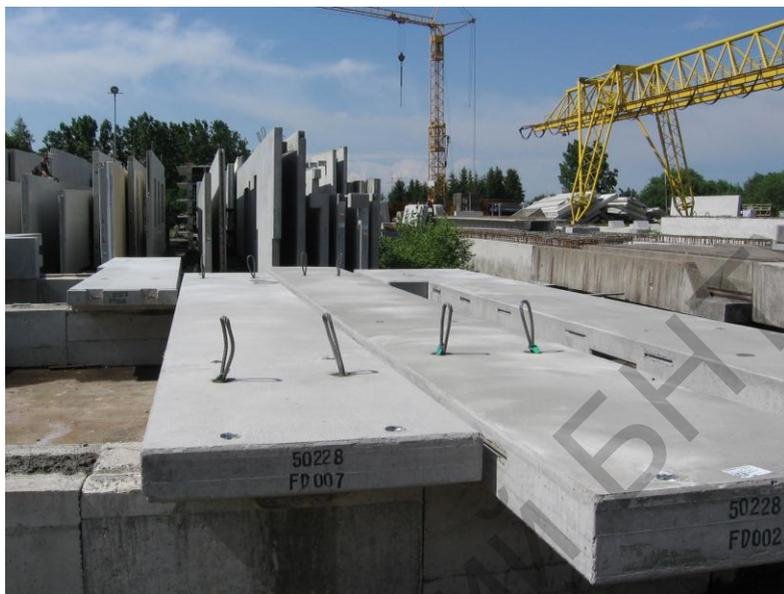
Рисунок 2. Панели перекрытия с упрощённым профилем
