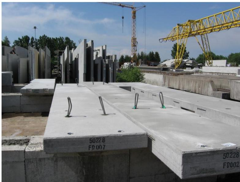
Рисунок 2. Панели перекрытия с упрощённым профилем
