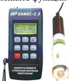
Рисунок 2. Измеритель прочности строительных материалов “ОНИКС-2.6”
