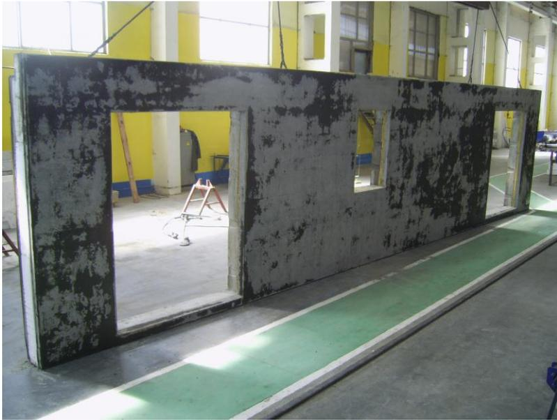
Рисунок 4. Экспериментальная 3-слойная наружная стеновая панель длиной 1 2м с термическим сопротивлением  $4.5 \text{ м}^2 \cdot \text{С}/\text{Вт}$
