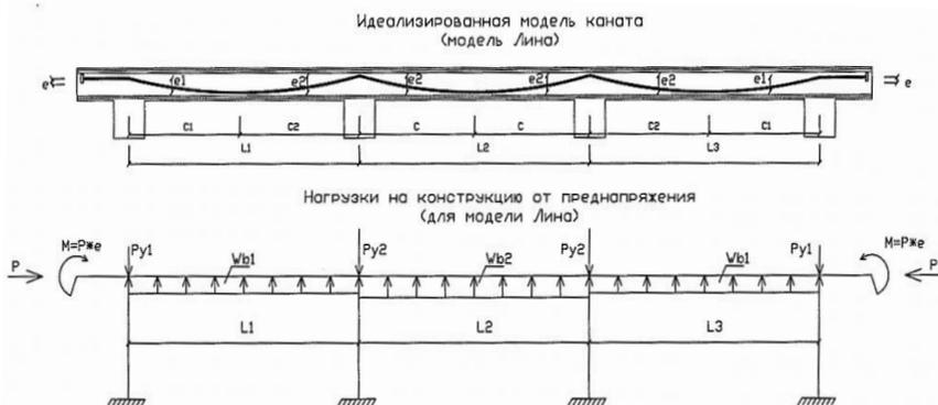
Рисунок 1. Идеализированная модель арматурного каната (по модели Лина)
