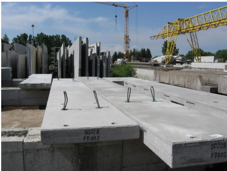
Рисунок 2. Панели перекрытия с упрощённым профилем
