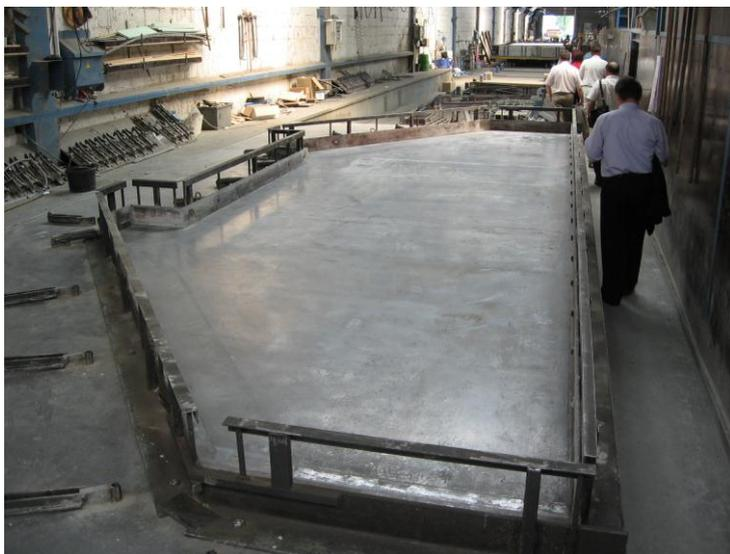
Рисунок 3. Производство стеновой панели нестандартной формы
