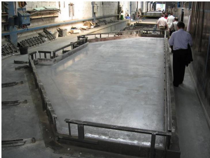
Рисунок 3. Производство стеновой панели нестандартной формы
