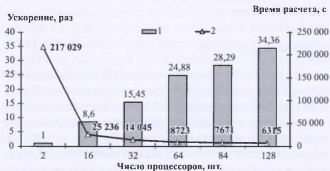
Рис. 2. Влияние числа процессоров на ускорение и время моделирования для отливки «Угольник» (число расчетных элементов 1 501 522)
