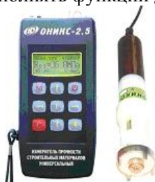
Рисунок 2. Измеритель прочности строительных материалов “ОНИКС-2.6”
