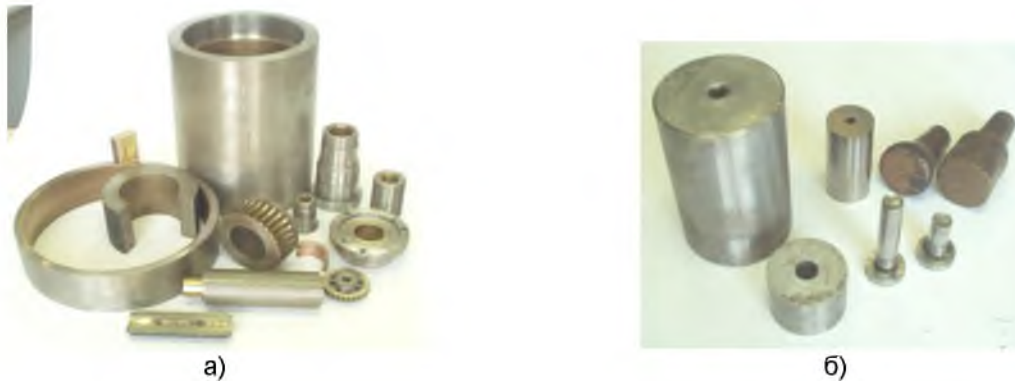
Рисунок 24 – Детали узлов трения и сопряжения с наплавленными износостойкими и антифрикционными порошковыми покрытиями
