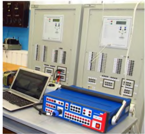
Рисунок 17 – Аппаратно-программный испытательный комплекс для проверки работоспособности цифрового реле МР 801
