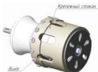
Рис. 4. Крепление крепежного стакана
