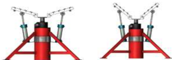
Рис. 2. Регулирование охвата по диаметру трубопровода
