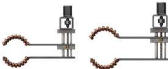
Рис. 2. Регулировка охвата соленоида
